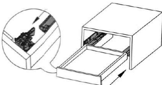
4- Para el retiro, presione y sostenga el mango y extraiga del cajón
