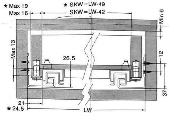
★Instalación para el cajón con espesor máximo de 19mm del cajón lateral.
