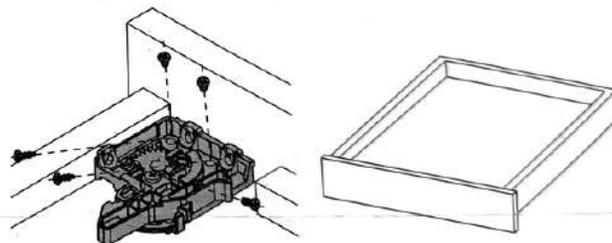
3- Deje el fondo del cajón en la corredera y empuje el cajón en el mueble
