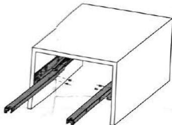
2- Fijar el dispositivo de cierre en la parte inferior del cajón
