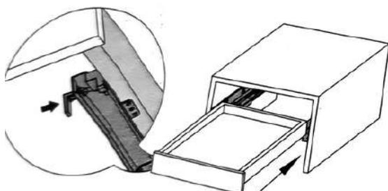
4- Para quitarlo, hale el seguro del costado del cajón. Suba el cajón y tire hacia fuera del gabinete.
