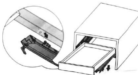
3- Presione el pasador de bloqueo en el lado del cajón para fijar la posición de la gaveta
