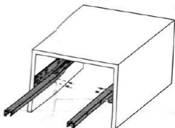
2- Hale hacia afuera el cajón tirando de los laterales de la corredera
