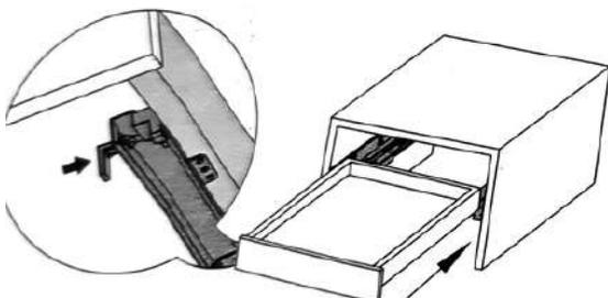
4- Para quitarlo, hale el seguro del costado del cajón. Suba el cajón y tire hacia afuera del gabinete.
