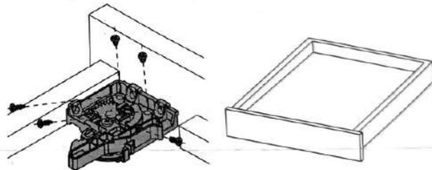
3- Deje el fondo del cajón en la corredera y empuje el cajón en el mueble
