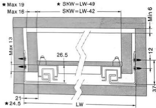
★Instalación para el cajón con espesor máximo de 19mm del cajón lateral.
