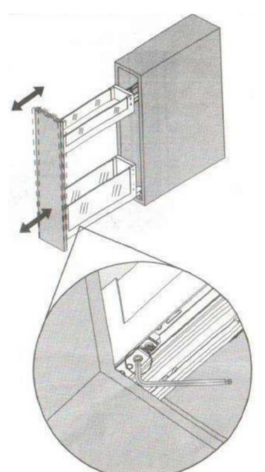
Ajuste de inclinación (mediante llave allen m3)
