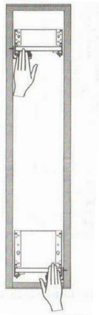
Presione el frente del cajón sobre las guías montadas
