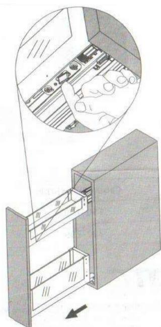
Presione las palancas de liberación debajo del fondo del cajón y extraiga el cajón.
